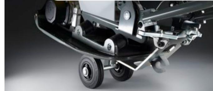
La placa de deslizamiento para adoquines (accesorio) sirve para proteger superficies de adoquines sensibles a la vibración. Se monta muy rápido con solo dos tornillos.
