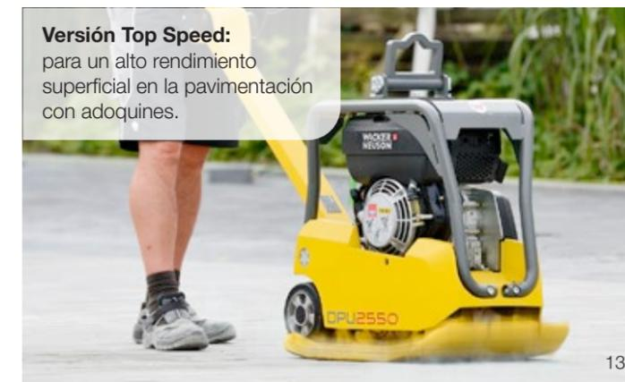
**Versión Top Speed:** para un alto rendimiento superficial en la pavimentación con adoquines.
