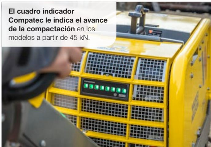
El cuadro indicador Compatec le indica el avance de la compactación en los modelos a partir de 45 kN.
