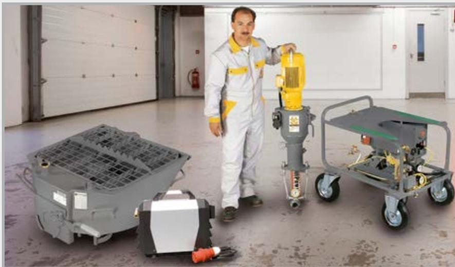
La MP 25 Mixit puede ser desmontada en cómodos módulos individuales para su traslado a cualquier lugar.
