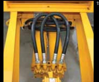
El sistema opcional de cambio de lado vástago o lado pistón está diseñado para ser rápido y fácil, para facilitar el rendimiento o la presión, cuando sea necesario.
