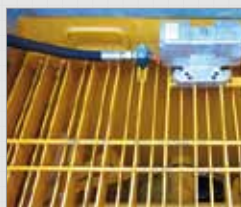
4 Tolva diseñada para shotcrete
